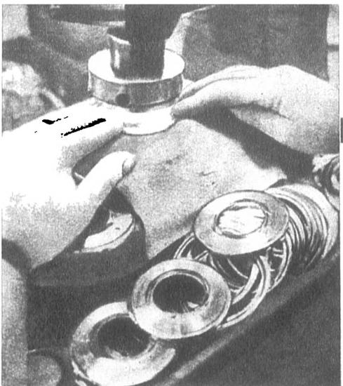
Машинний та ручний монтаж томпакових пудрениць (томпак — суміш міді, цинку та латуні), дві з 60 операцій, з яких складається процес виробництва пудрениць.
