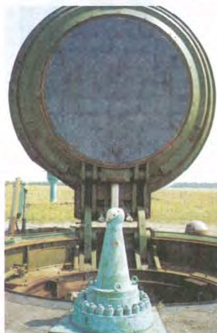
Кришка вагою 120 т шахтно-пускової установки ракетного комплексу „ОС” (на передньому плані антена приймання команди штабної ракети на запуск)
